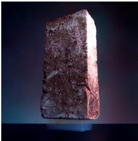
Un blocco di pietra di 2,5 kg è sostenuto da una base di aerogel pesante solo 2 grammi
